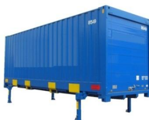
Рисунок 5.6. Съемный кузов, стоящий на опорах
