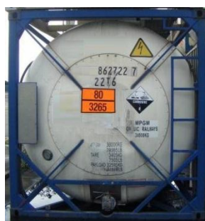
Рисунок 8.2. Лестница на частичную высоту каркаса
