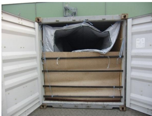
Рисунок 7.54. ГТЕ с мешком-вкладышем для размещения чувствительного навалочного груза
