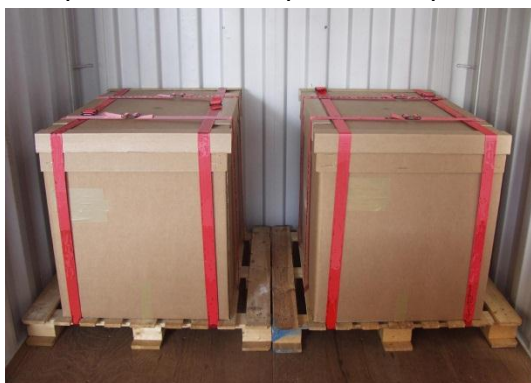
Рисунок 7.8. Груз, прочно закрепленный на поддонах найтовыми из текстиля
