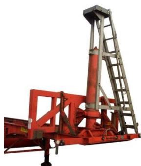
Рисунок 8.9. Установленная на трейлере лестница для доступа
