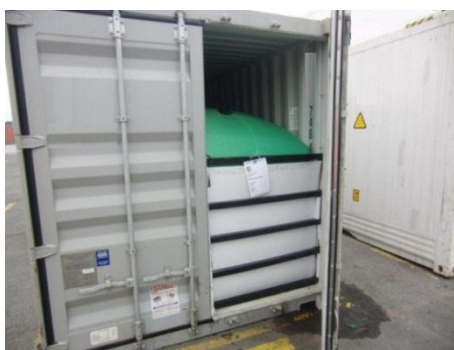
Рисунок 7.51. Контейнер с установленным внутри мягким танк-контейнером
