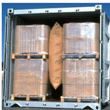
Рисунок 7.9. Заполнение пустоты по центру с помощью пневмооболочки
