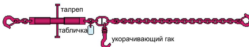
Рисунок 7.18. Стандартный цепной найтов с укорачивающим гаком
