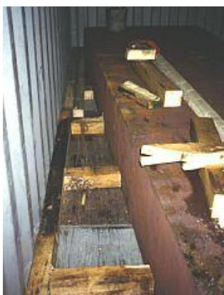
Рисунок 7.45. Поперечная блокировка стальной плиты
