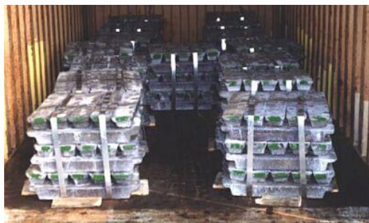
Рисунок 7.19. Металлические слитки, объединенные с помощью стальной обвязки (процесс крепления не закончен)
