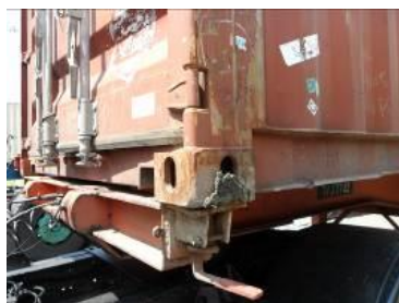
Рисунок 6.2. Грязь в угловом фитинге
