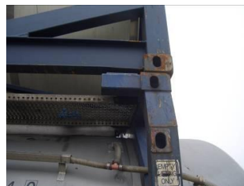
Рисунок 4.9. Уступ у вспомогательного бокового отверстия для подъема
