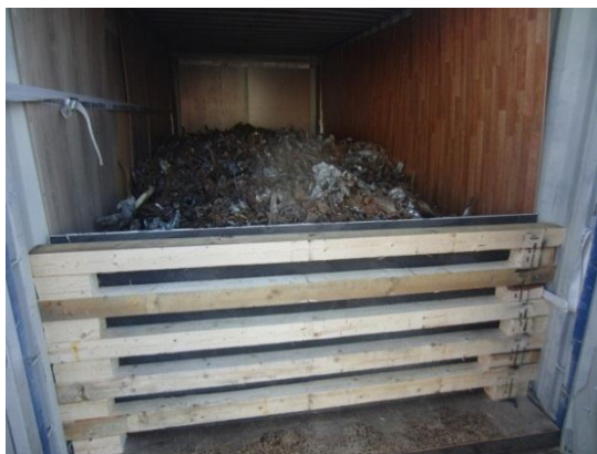
Рисунок 7.55. Загруженная ломом ГТЕ с облицовкой стен и барьером у дверей
