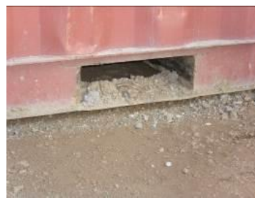
Рисунок 6.3. Грязь в кармане для вилочных автопогрузчиков
