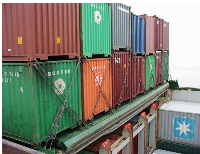
Рисунок 2.2. Направляющие ячейек и контейнерные штанги на судне-контейнеровозе
