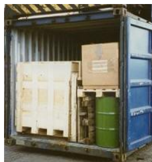
Рисунок 7.28. Смешанная укладка, использование поддонов
