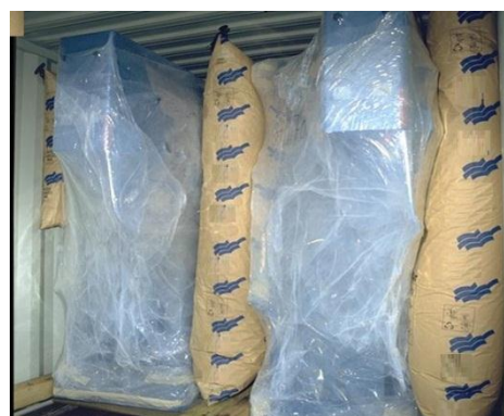
Рисунок 7.10. Блокировка пневмооболочками упаковок неправильной формы
